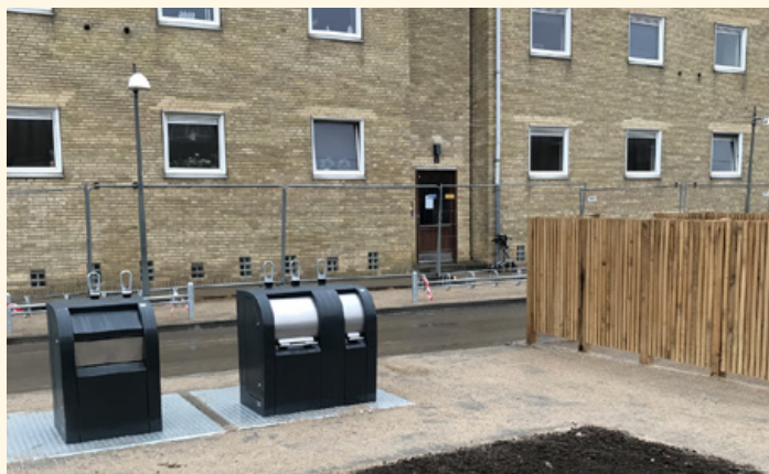
Nyt fælles affaldssystem med nedgravede beholdere (Vestgavl)
